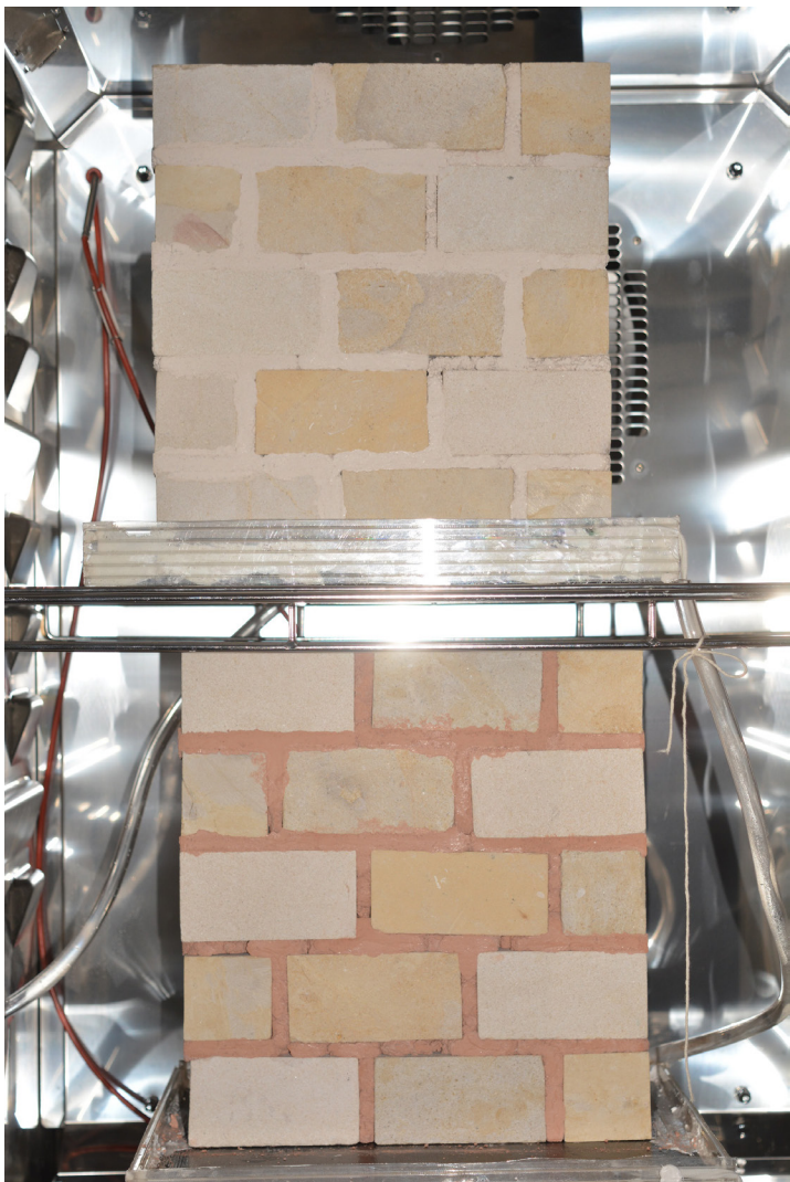
Les deux murets construits dans l'enceinte climatique
