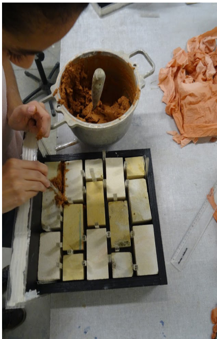
Construction des murets à échelle réduite en laboratoire
